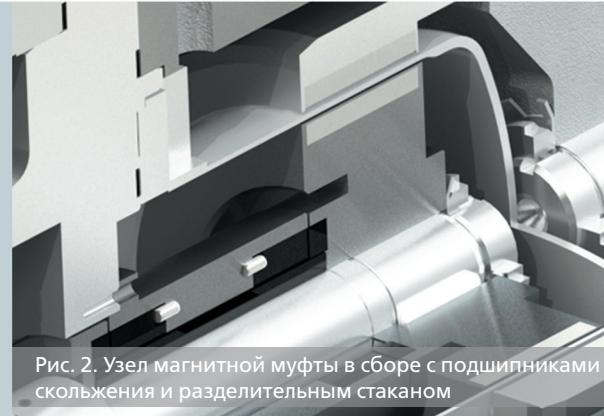
Рис. 2. Узел магнитной муфты в сборе с подшипниками скольжения и разделительным стаканом
