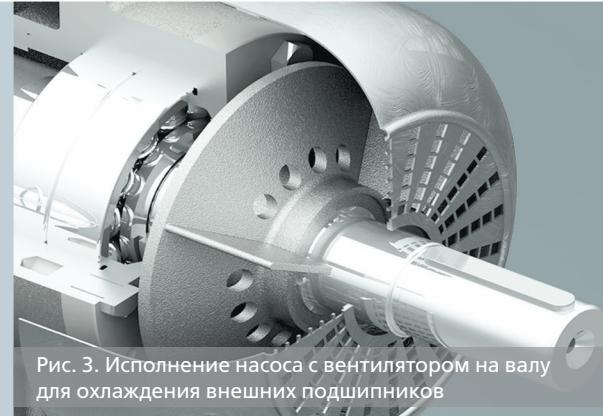
Рис. 3. Исполнение насоса с вентилятором на валу для охлаждения внешних подшипников
